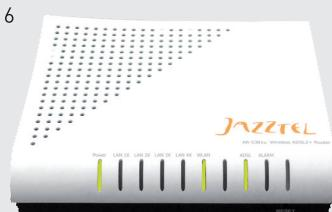
**Asegúrate de que tras este paso, el router sigue sincronizado -Fig. 6- (luz ADSL fija).**
